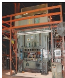
300 Ton Minster Hevi-Stamper Model E2-300-54-36 SSDC Press
