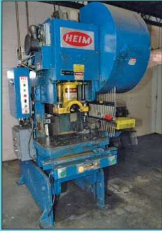
55 Ton Heim Model 5A F.W. Flywheel Type OBI Press
