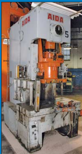
121 Ton Aida Model C1-11(2) Gap Frame Press
