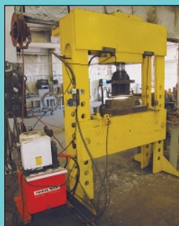
200 Ton Mfg. Unknown Hydraulic H-Frame Press
