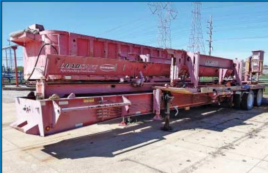
**Schramm Load Safe Pipe Handling System**
