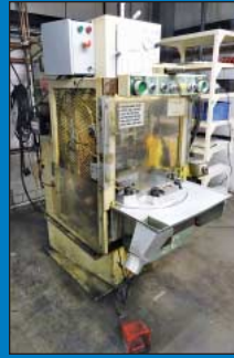
10 Ton Greenerd Model HPB-10 C-Frame Press
