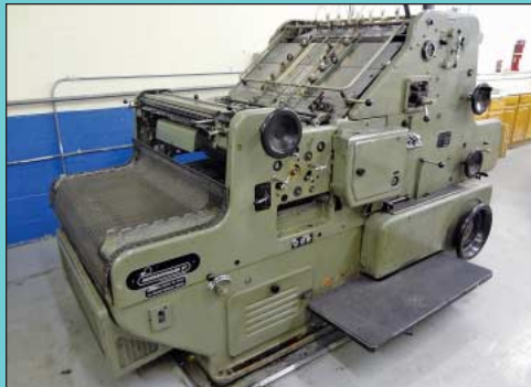
22" X 31" Mergenthaler 31 Bed Type Die Cutting Press
