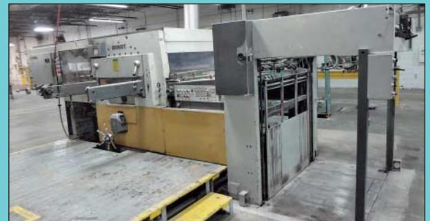
36" X 49" Bobst Model Autoplatten SP126-E Automatic Die Cutter
